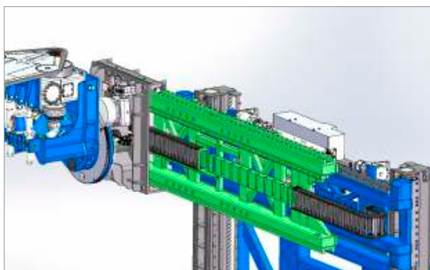
Trave movimento orizzontale - asse X1 Horizontal movement beam - X1 axis
