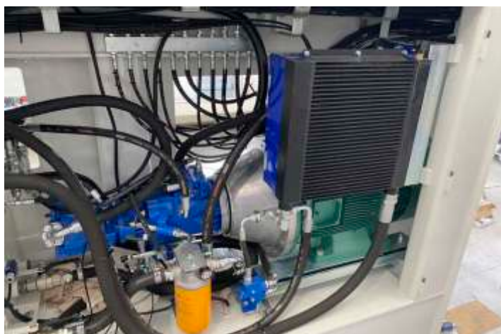
Particolare della centralina idraulica e della motopompa principale Detail of the hydraulic unit and the main pump
